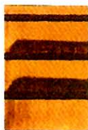
T16 Jasno definisane tamne površine sa nagorelim ivicama lamele Uzrok: Izdignuta izolacija (vidi L6)
